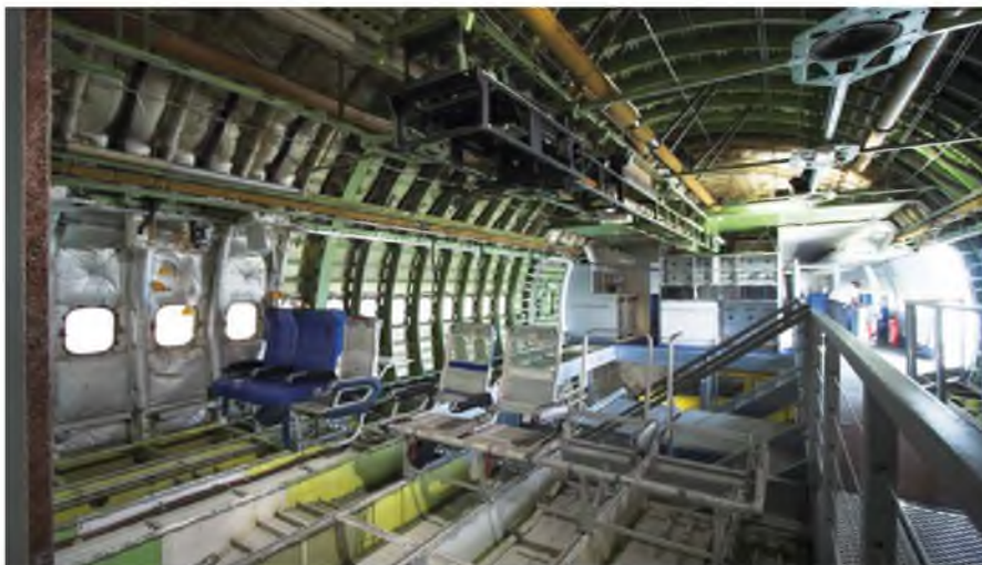
3.3-14. Półskorupowa konstrukcja współczesnego samolotu pasażerskiego.
