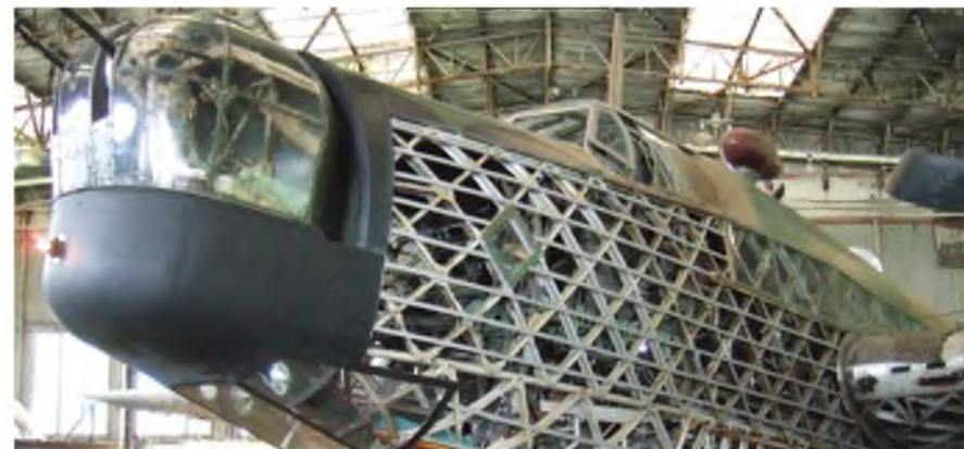
3.3-15. Vickers Wellington Mk.I, brytyjski bombowiec zaprojektowany w latach 30. przez słynnego inżyniera i wynalazcę Barnesę Wallisa. Konstrukcja oparta na strukturze geodezyjnej zapewniała mu wyjątkową wytrzymałość i odporność na uszkodzenia.
