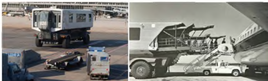
3.4-17. Washington Dulles International Airport jest jednym z niewielu lotnisk (obok m.in. Meksyku i Montrealu), które korzystają jeszcze z mobilnych poczekalni-rękawów zbudowanych wraz z terminalem Eero Saarinen w latach 1958–1963. Oryginalny pojazd skonstruowany przez Chyslera, mieszczący ok. 100 osób, dostosowujący swoją wysokość do poziomu w różnych typach samolotów, miał rozwiązać problem szybkiego pokonywania odległości pomiędzy stanowiskami postoju samolotów i terminalem. Po rozbudowie wielkość lotniska Dullesa wymagała wprowadzenia bardziej wydajnych środków transportu pasażerów pomiędzy pirsami w postaci specjalnych pociągów zwanych Aerotrain. Tego typu pociągi należące do systemów automatycznych kolejek ( automated people mover , APM) obsługują także m.in. wewnętrzną komunikację na lotniskach w Singapurze, Atlancie, Denver, Rzymie czy Madrycie.
