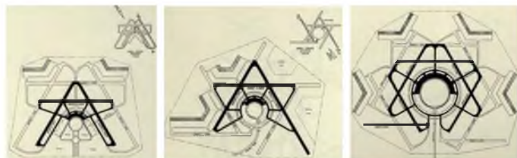
3.2-5. Schematy konfiguracji dróg startowych, terminali, zabudowy towarzyszącej i dróg dojazdowych. Rysunki pokazują ścisłe zależności pomiędzy geometrią układu dróg startowych i zasadą kształtowania planu terminalu. Świadczą też o usilnych próbach zapanowania nad złożoną grą wzajemnych zależności elementów lotniska i poszukiwaniu rozwiązań modelowych, pozwalających na budowanie wielostopniowych systemów konfiguracji. F. Charles, P. Walther, Airport Planning , New York–London 1946.
