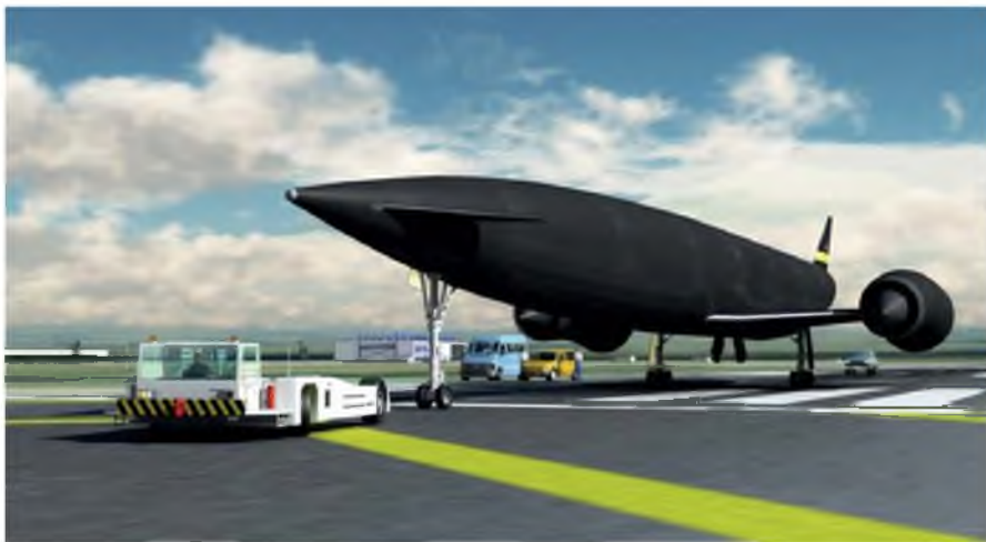
7.1-8. Skylon, samolot kosmiczny, który ma stratawać i lądować na zwykłym pasie startowym, mogący zabierać na niską orbitę okołoziemską pasażerów i ładunek. Zakłada się, że projekt brytyjskiej firmy Reaction Engines Limited będzie gotowy do 2019 r.
