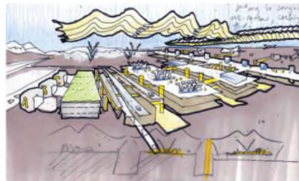
4.3-6. Terminal T4 na lotnisku Madryt-Barajas, Richard Rogers, Estudio Lamela, 2006. Szkic autorski. Rysunek wyjaśnia koncepcję zmierzającą do wywołania wrażenia, że spoczywająca na ziemi „funkcjonalna maszyna” jest osłonięta unoszącym się nad nią lekkim lewitującym dachem.
