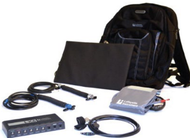
Ryc. 5. Zestaw z poligrafem komputerowym LX6 (producent: Lafayette Instrument Co.)
